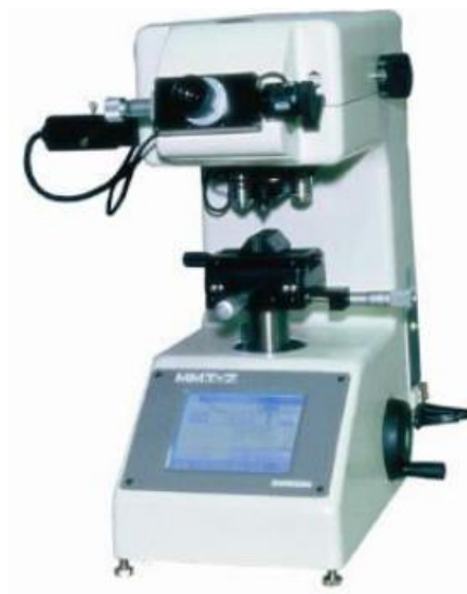
Slika 3.9 Uređaj za ispitivanje tvrdoće po Knoopu [11]
