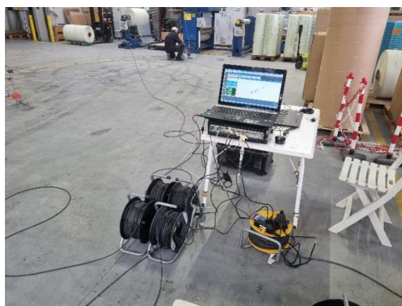
Slika 7.12 Mjerna stanica za provedbu statičkog i dinamičkog ispitivanja
