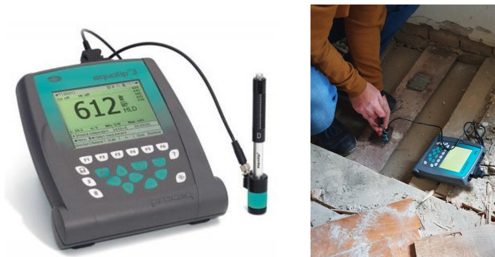
Slika 3.11 Prikaz Leeb uređaja za mjerenje tvrdoće [31]
