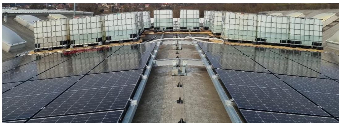
Slika 7.11 Faza 4 statičkog ispitivanja (400 l vode u 24 spremnika – lijevo i desno na slici i 600 l vode u 2 spremnika – u sredini na ovoj slici)
