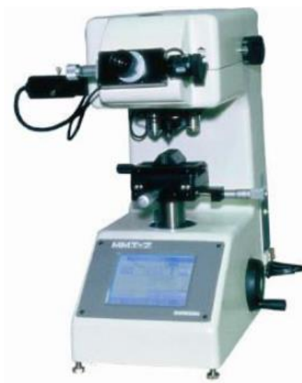
Slika 3.9 Uređaj za ispitivanje tvrdoće po Knoopu [11]
