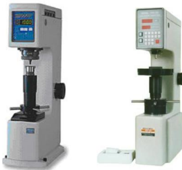
Slika 3.6 Uređaj za ispitivanje tvrdoće po Rockwellu [11]
