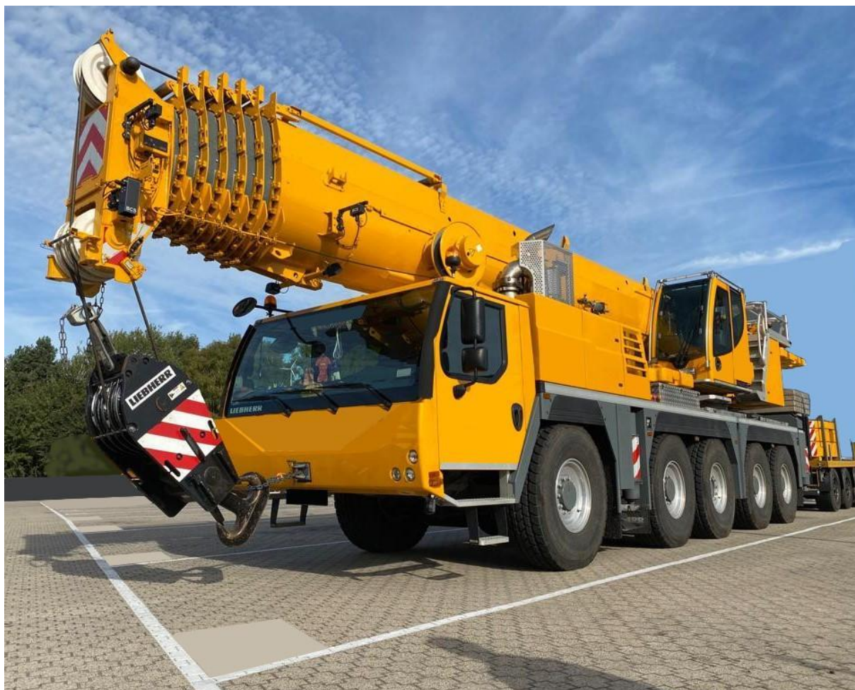
Slika 31 Autodizalica Liebherr LTM 1150
