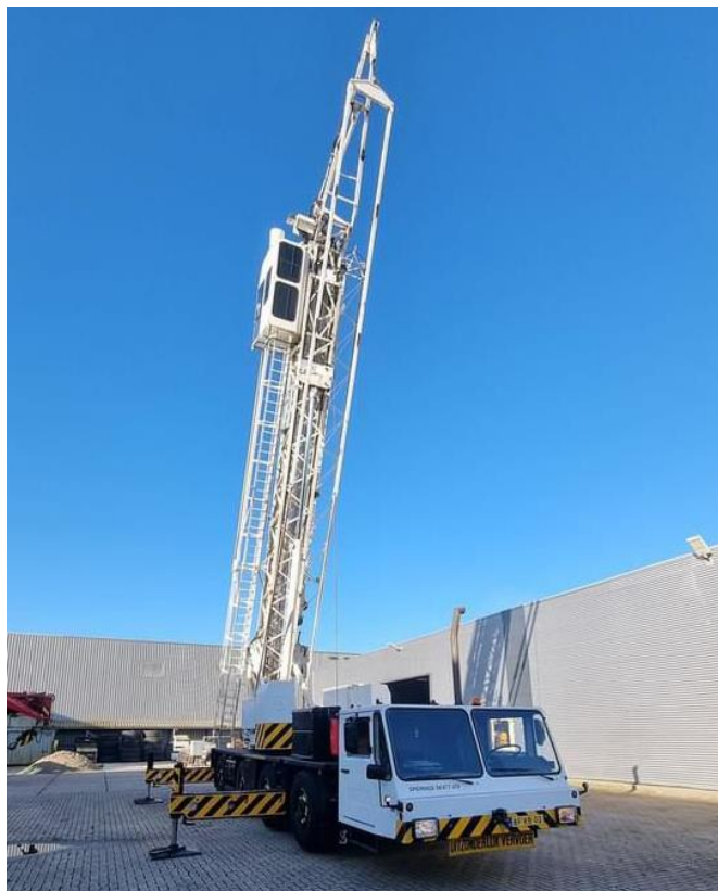
Slika 39 Mobilna toranjska dizalica
