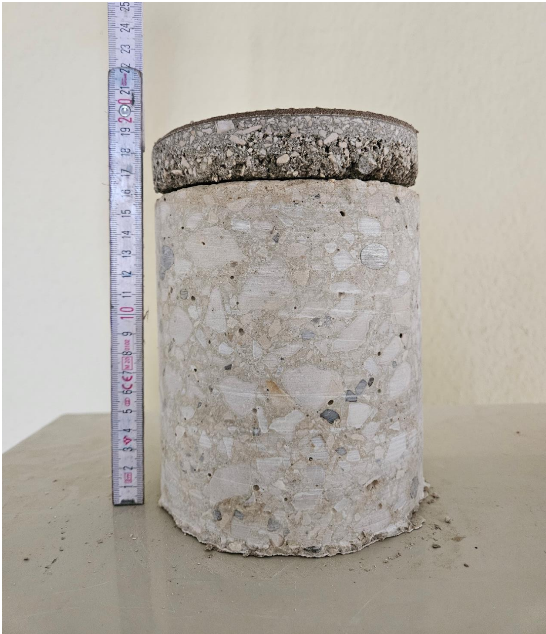
Slika 18. Uzorak izrezan iz AB stropne ploče
