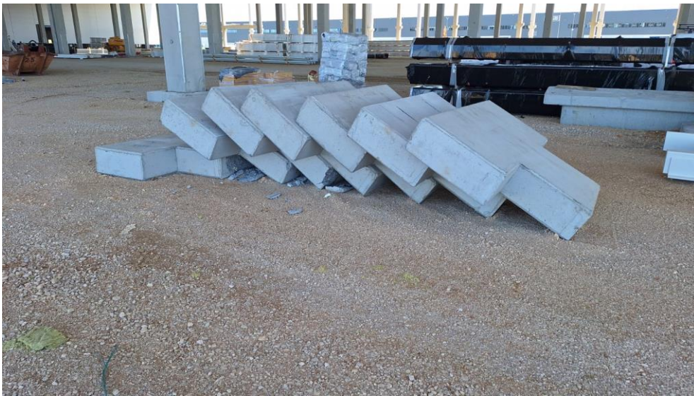
Slika 19: Mehanički lom fasadnih dokova
