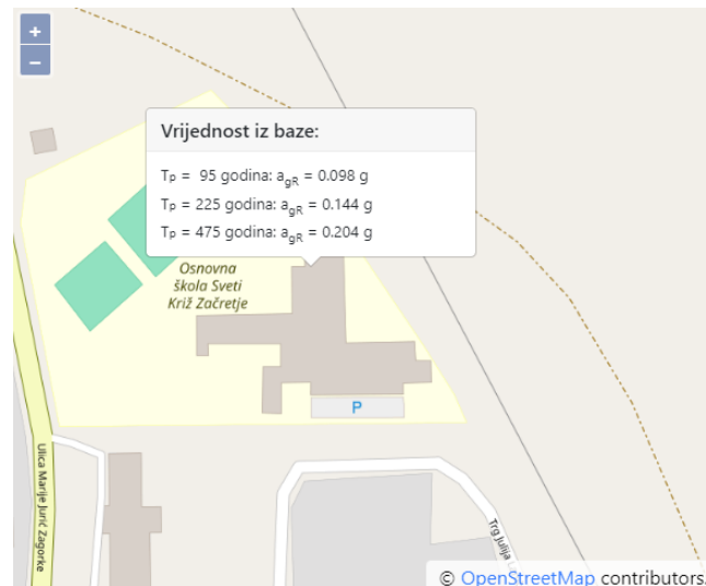
Slika 27: Vrijednosti horizontalnih vršnih ubrzanja tla tipa A na lokaciji građevine (Izvor: [9])
