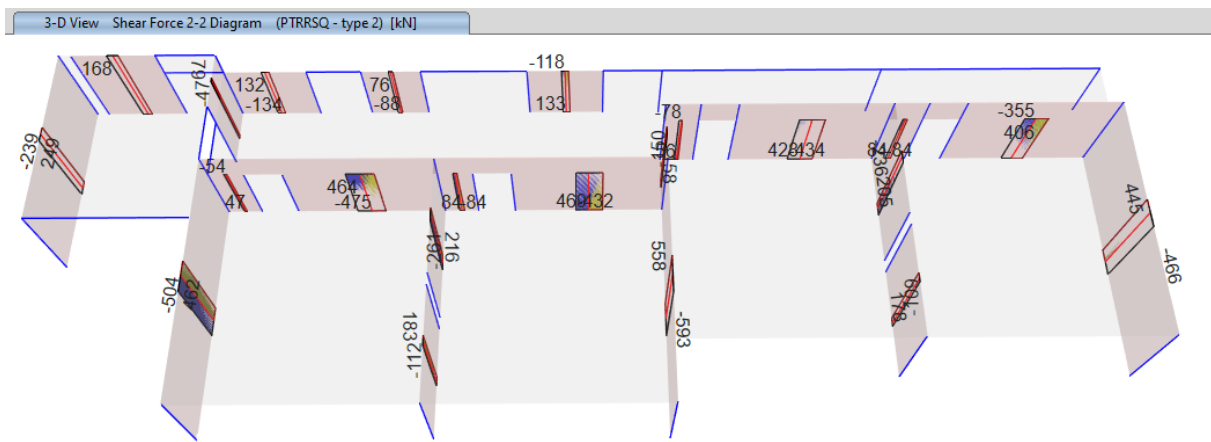
Slika 131: Raspodjela poprečnih sila integriranih po dužini zida prizemlja od mjerodavne kombinacije PTRRSQ [kN]
