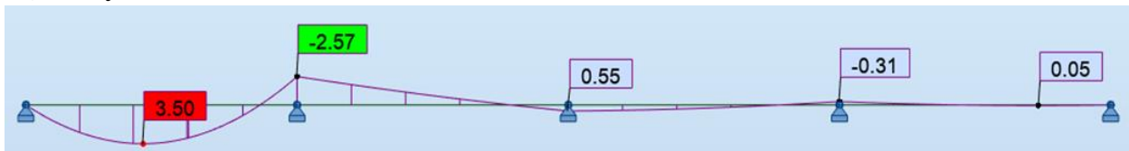
Slika 10.21. Maksimalan pozitivni moment savijanja
