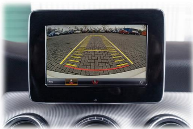
Slika 3. Prikaz zaslona u kopitu tijekom vožnje unatrag [15]
