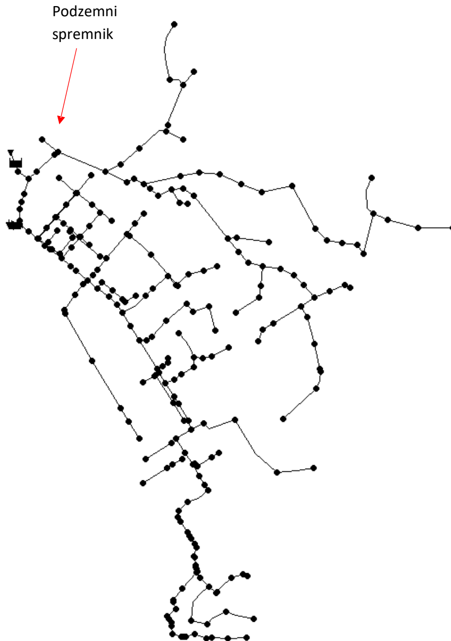
Slika 16. SWMM model varijante A sa podzemnom retencijom
