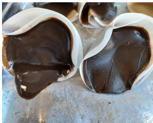
Slika 4. Priprema mulja postupkom filtracije za proces sušenja i žarenja
