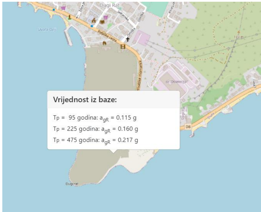
Slika 10 – horizontalno vršno ubrzanje tla – Potresna karta Hrvatske [6]
