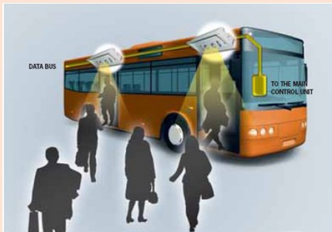
Slika 6-1: Primjer primjene automatskih brojača putnika u mreži javnog prometa
