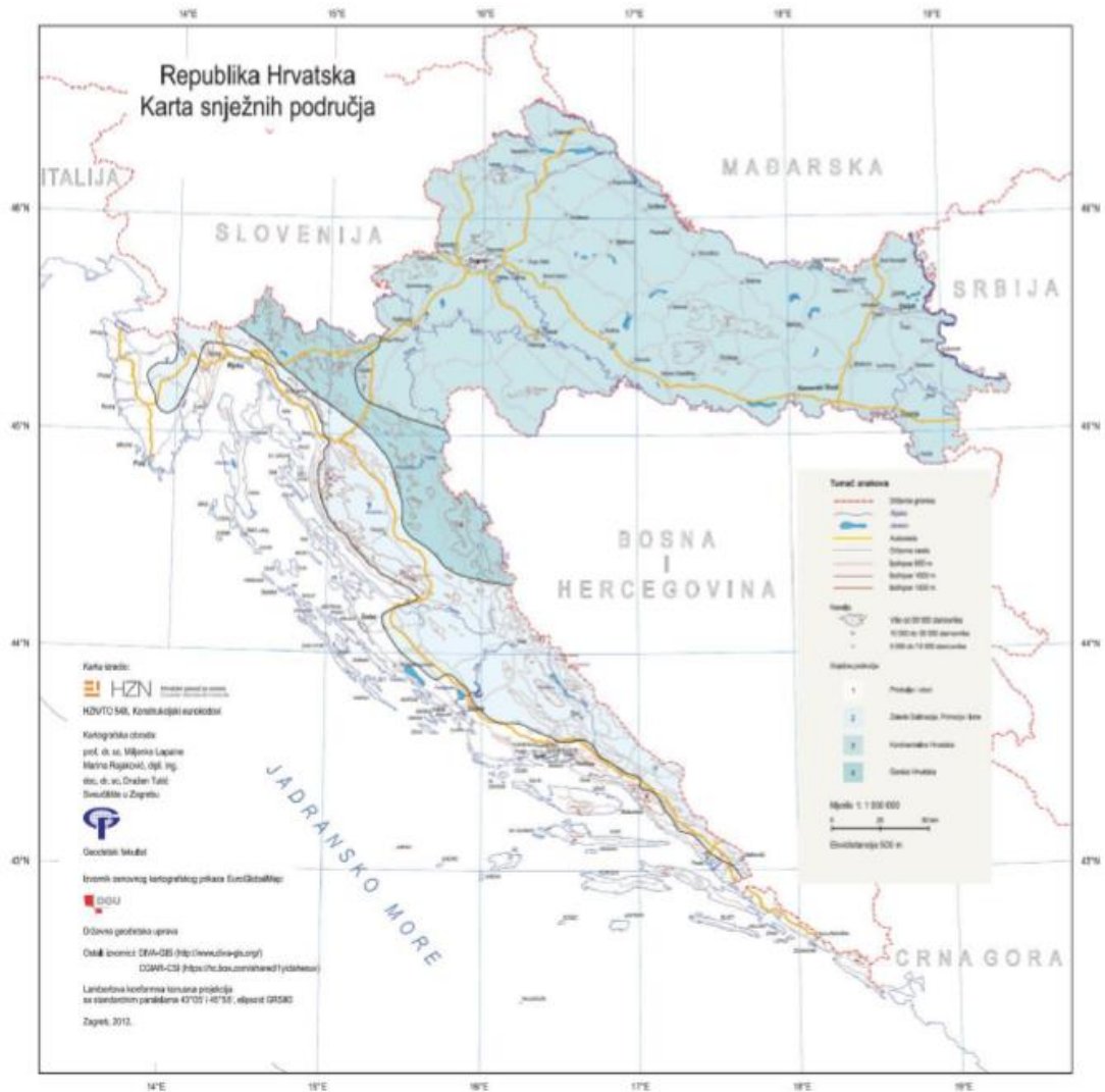
Slika 3: karta karakterističnog opterećenja snijegom
