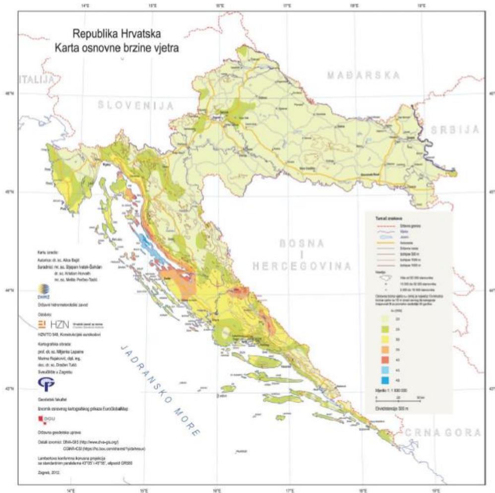
Slika 4: karta karakterističnog opterećenja vjetrom
