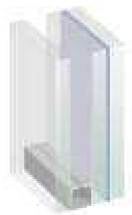
Slika 39: Shema detalja obloge s monolitnom pločom s jedne strane i laminiranom pločom s druge strane (Izvor: [65])
