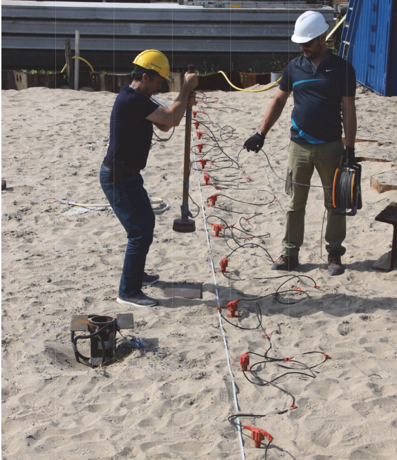
Slika 2. Detalj provedbe MASW ispitivanja
