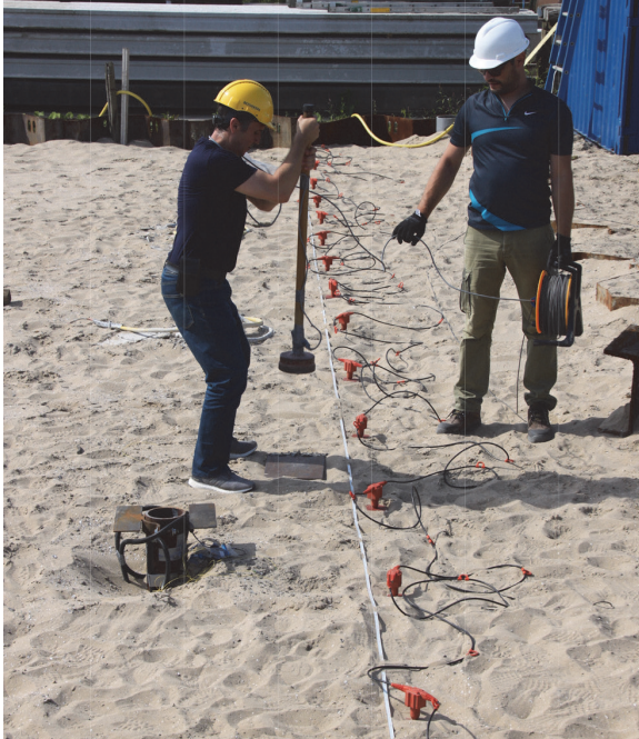
Slika 2. Detalj provedbe MASW ispitivanja
