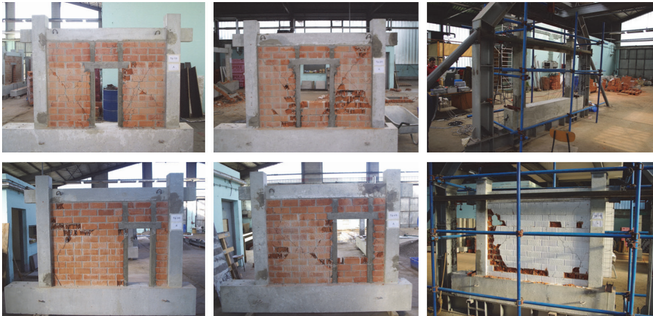
Slika 2. Ispitane u mjerilu 1:2,5 izvedene modelske armiranobetonske okvirne konstrukcije s ispunskim zidom u kojemu se nalaze omeđeni otvori, i zidne bez otvora (Penava, 2012; Sigmund and Penava, 2014)
