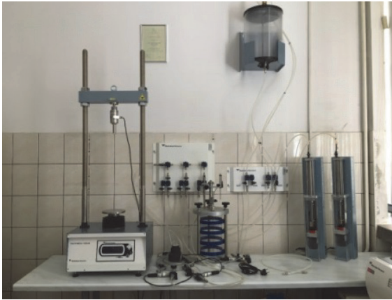
Slika 2. Uređaj s troosnom ćelijom na Građevinskom fakultetu u Zagrebu
