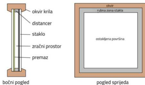
Slika 9.: Grafički prikaz okvira prozora, rubne zone stakla i središnje ostakljene zone. (Izvor: [16])
