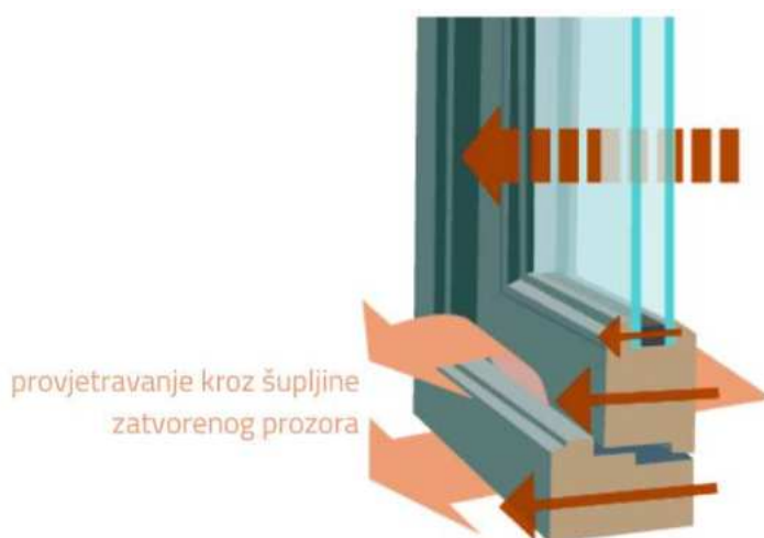
Slika 7.: Provjetravanje kroz šupljine profila zatvorenog prozora (Izvor: [14])
