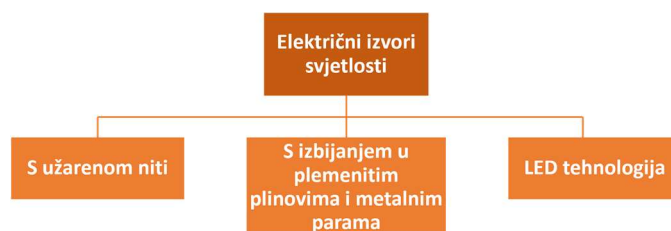
Slika 6.: Podjela električnih izvora svjetlosti (Izvor: [3])
