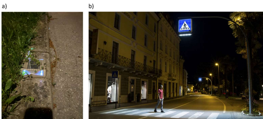
Slika 20.: a) trepereće prizme kraj pješačkog prijelaza, b) prometni znak s LED lampom (Izvor: autor, [14])
