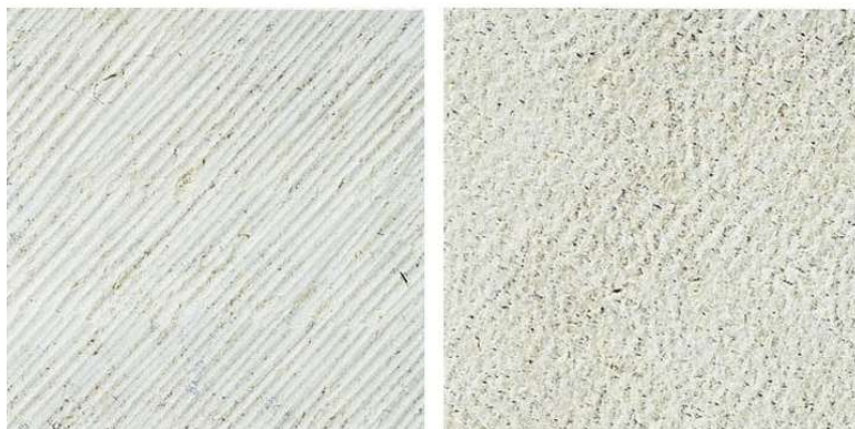
Slika 13: Brazdana (lijevo) i štokovana površina (desno) (Izvor: [27])
