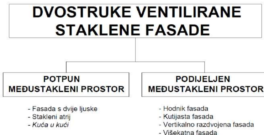
Slika 29: Prikaz sistematike dvostrukih ventiliranih fasada (Izvor: [6])
