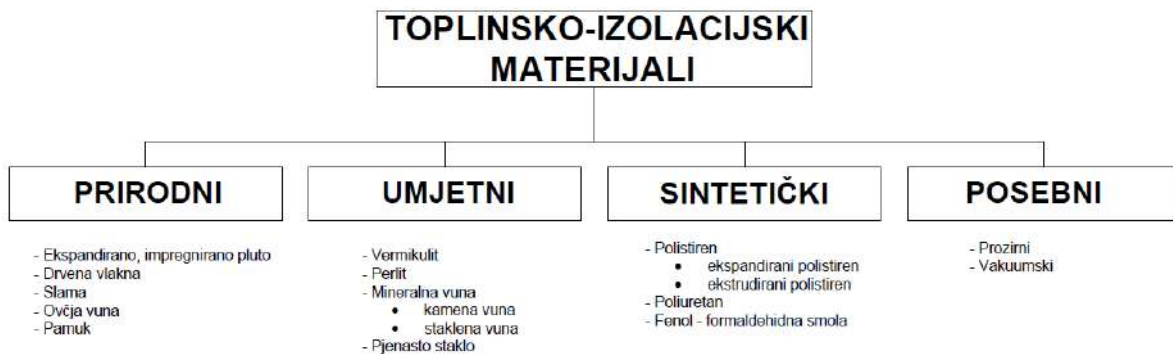
Slika 3: Prikaz sistematizacije toplinsko izolacijskih materijala (Izvor: [6])
