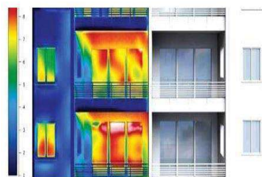
Slika 2: Kritična područja za pojavu toplinskih mostova (Izvor: [7])
