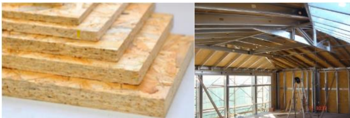
Slika 5.: OSB ploče različitih dimenzija i njihova aplikacija ( Izvor: [2])
