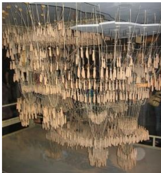
Slika 20.: Reprodukcijski model crkve u Coloniji Gúell (Izvor: [24])
