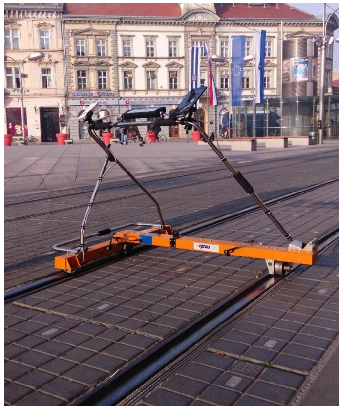
Slika 11.: Mjerna kolica za mjerenje geometrije kolosijeka (Izvor: [2])
