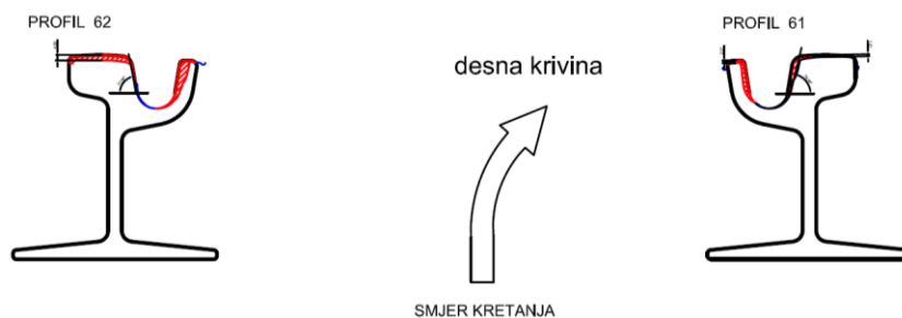
Slika 13.: Prikaz izmjenjenog profila istrošenja para tračnica u desnoj krivini (Izvor: [2])
