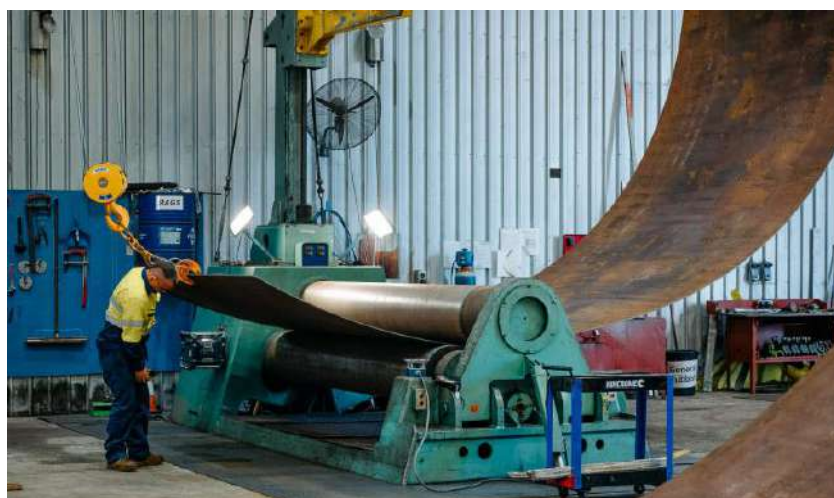
Slika 24: Savijanje ploče pomoću valjka
