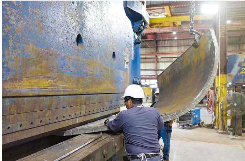
Slika 25: Savijanje ploče pomoću ravnog kalupa
