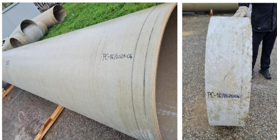
Slika 4.3 GRP cijev i uzorak cijevi za ispitivanje obodne krutosti (Izvor: [8])
