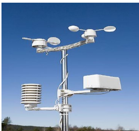
Slika 14: Osobna meteorološka stanica (izvor: [41]).
