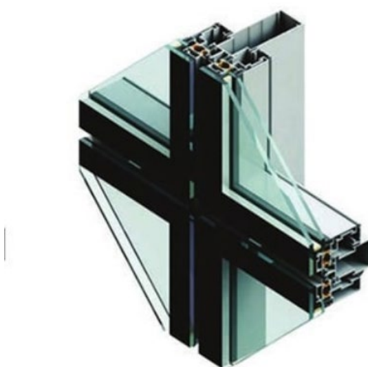
Slika 15.: Geometrija strukturalne fasade [8]
