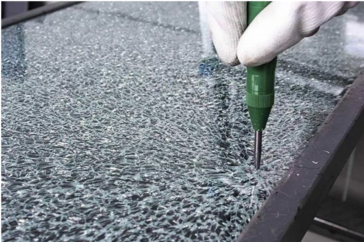
Slika 23.: Slom kaljenog stakla [8]
