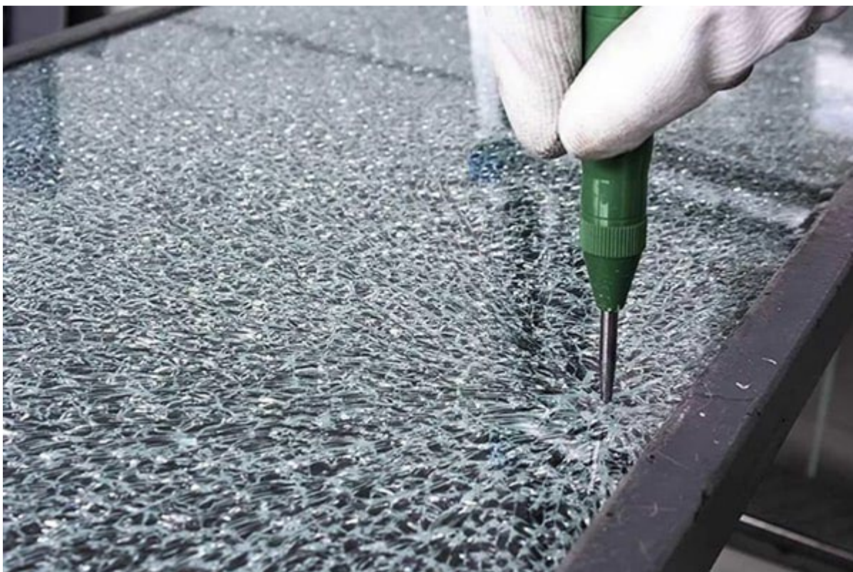
Slika 23.: Slom kaljenog stakla [8]
