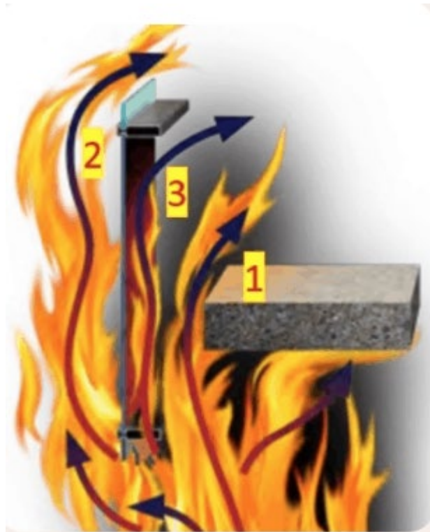
Slika 29.: 1: između podne ploče i unutarnje strane okvira, 2: preko vanjskog dijela fasade, 3: između šupljina u konstrukciji [23]
