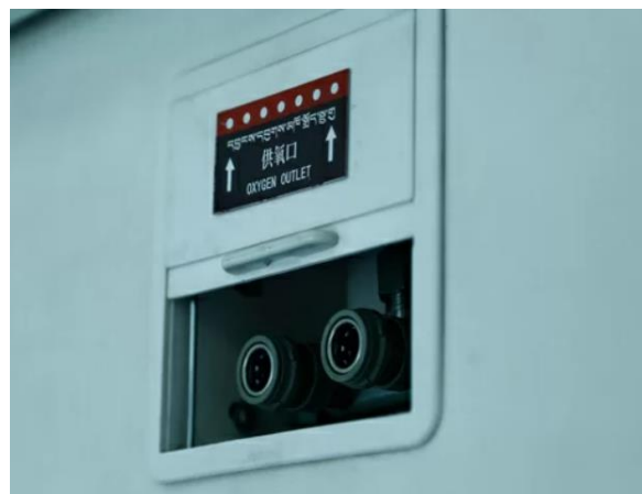
Slika 21 Ventil za kisik unutar vagona (Izvor: [22]).
