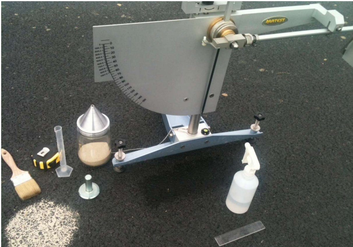
Slika 18: Ispitivanje hvatljivosti (HRN EN 13036-4) i teksture (HRN EN 13036-1) habajućeg sloja asfalta
