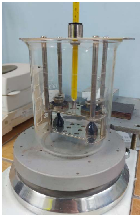
Slika 19: Ispitivanje točke razmekšanja prema normi HRN EN 1427
