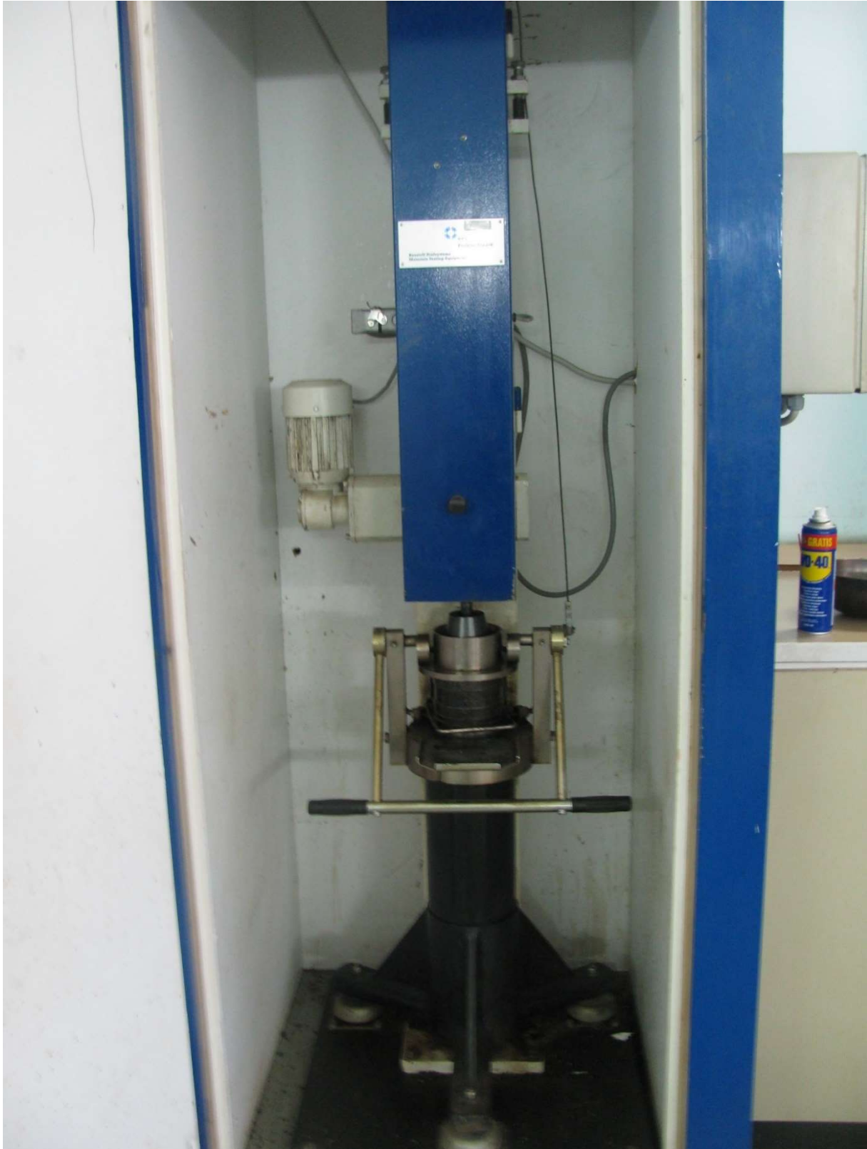
Slika 20: Zbijanje uzroka Marshallovim zbijaćem prema normi HRN EN 12697-30
