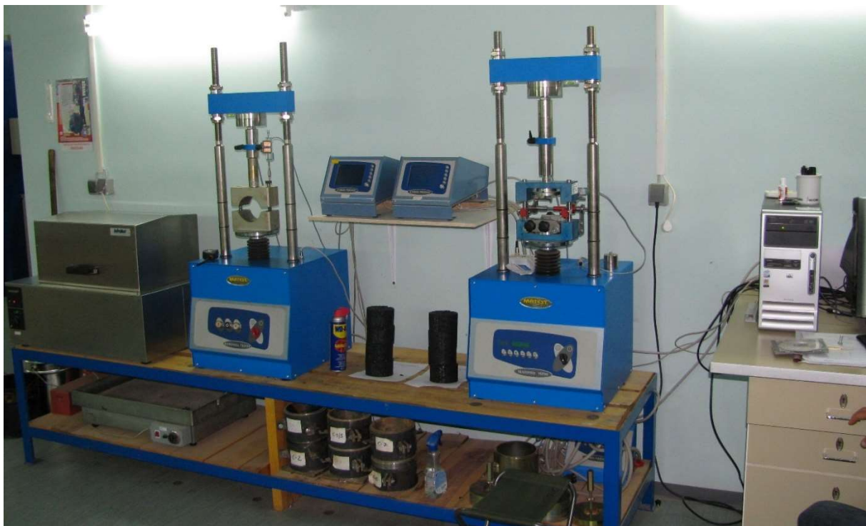
Slika 22: Preše za ispitivanje povezanosti slojeva asfalta (HRN EN 12697-48) i Marshallovih vrijednosti (HRN EN 12697-34)
