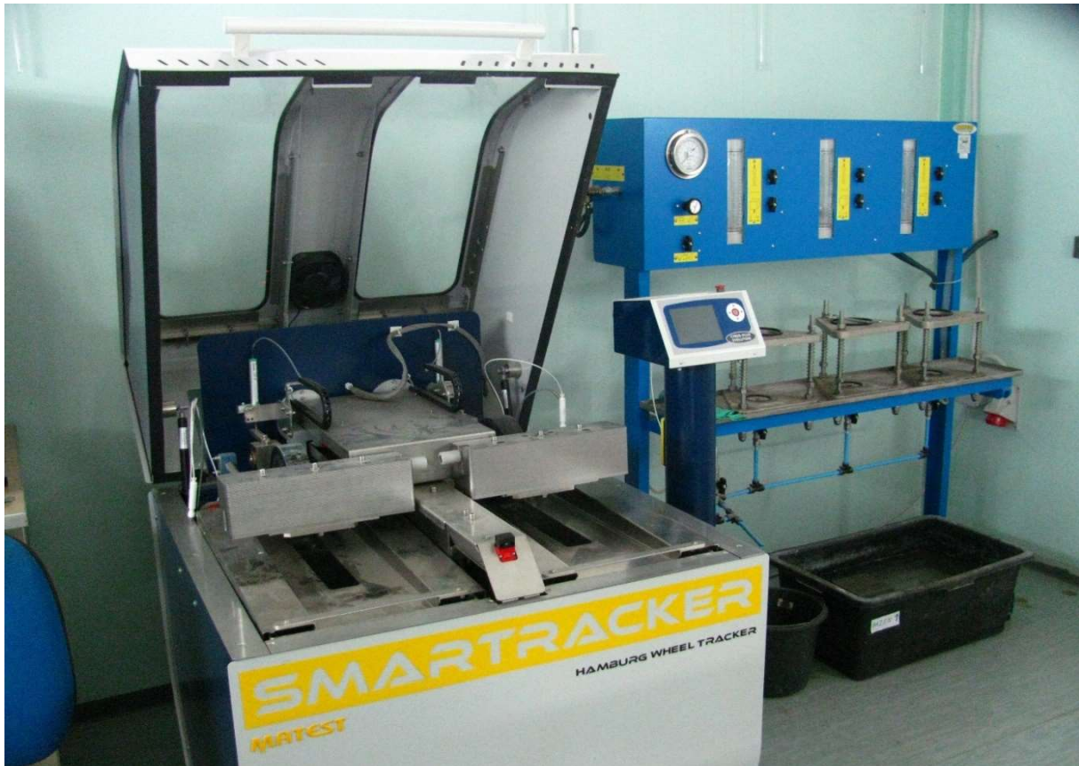
Slika 21: Uređaj za ispitivanje otpornosti na trajnu deformaciju prema normi HRN EN 12697-22
