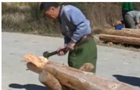
d) uklanjnje velikih komada drva pomoću sjekire
