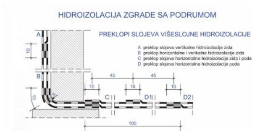
Slika 4. Detalji preklopa membrana
