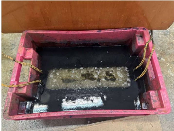
Slika 8: Pročišćavanje vode s uronjenom elektrodom od nehrđajućeg čelika
