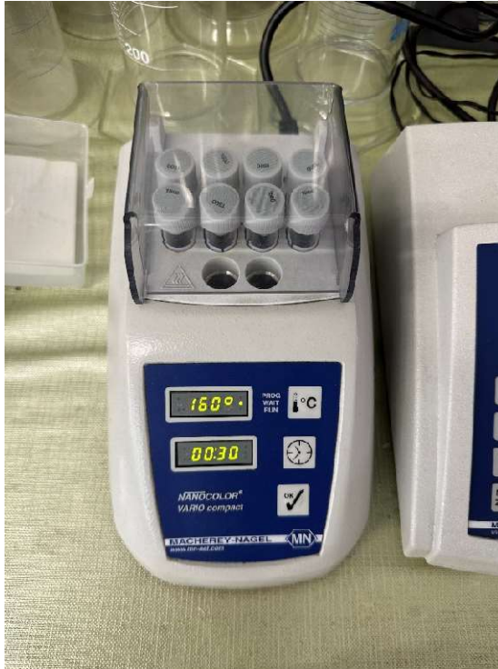
Slika 7: Termoblok za zagrijavanje uzoraka NANOCOLOR 500 D, Macherev Nagel
