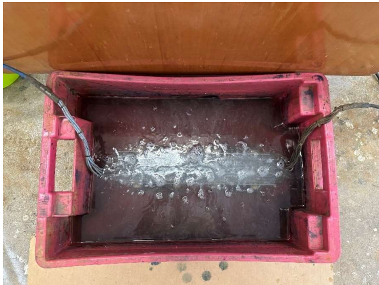
Slika 9: Pročišćavanje vode s uronjenom elektrodom od aluminija
