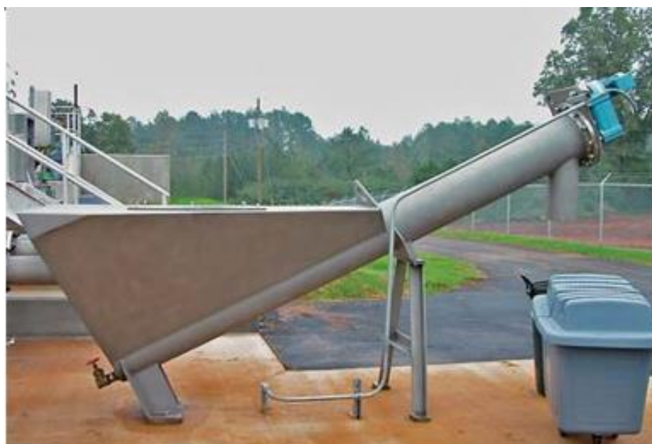
Slika 45: Uređaj za pranje pijeska SCHREIBER (Izvor:[5])
