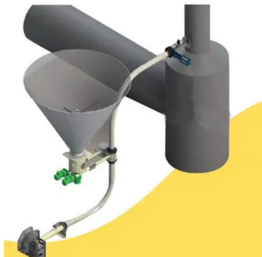
Slika 39: Pneumatski izbacivač (Izvor:[16])
