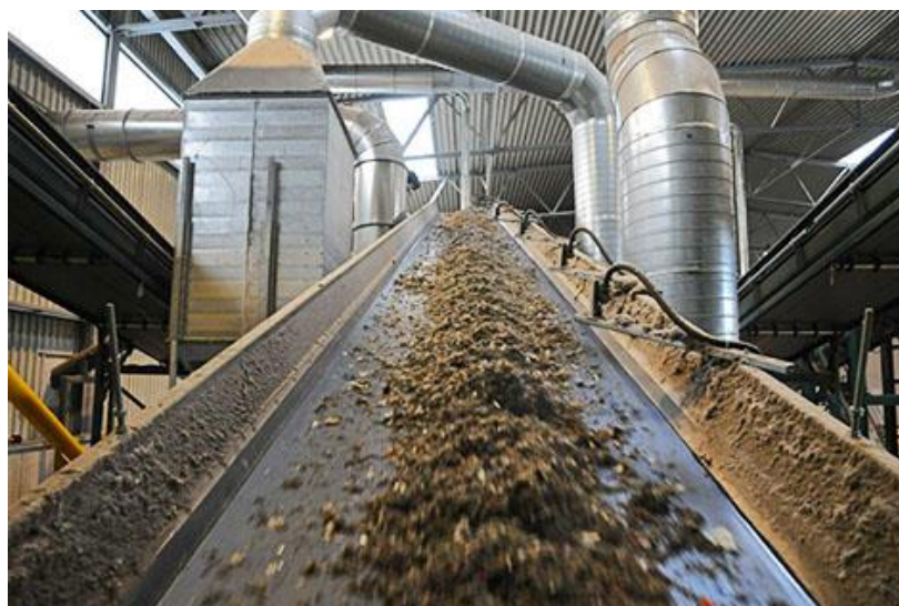
Slika 40: Transportna traka (Izvor:[17])
