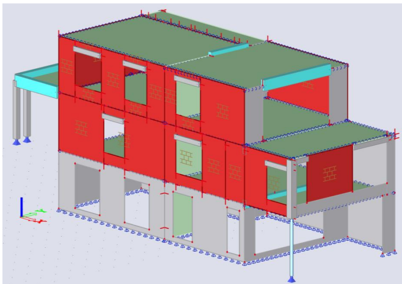
Slika 5 Prikaz 3D modela konstrukcije
