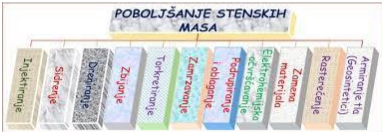
Slika 12: Shema metode poboljšanja stijenskih masa (Izvor: [13], Slika 8.)
