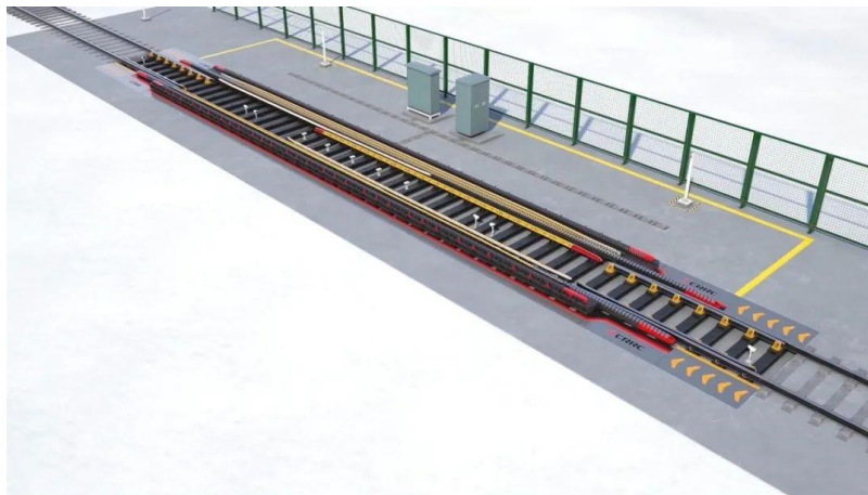
Slika 15.: Uređaj za promjenu kolosijeka na tlo [35]
