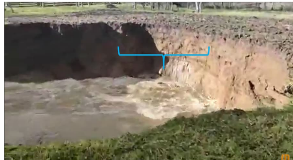
Slika 21 Nestabilnosti pokosa urušne vrtače -4 (Izvor: [10])
