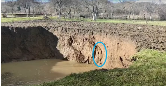
Slika 18 Nestabilnosti pokosa urušne vrtače - 1 (Izvor: [10])
