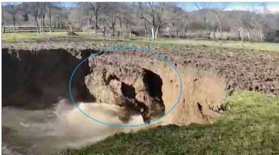
Slika 20 Nestabilnosti pokosa urušne vrtače - 3 (Izvor: [10])
