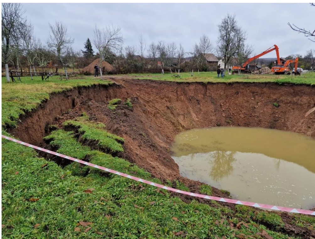
Slika 43 Urušavanje pokosa vrtače S001 - 23.11.2022. (Izvor: [14])
