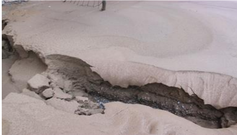
Slika 24. Pojava likvefakcije na terenu u Brestu Pokupskom (izdizanje pijeska na površinu kao klasični pokazatelj likvefabilnosti tla)
