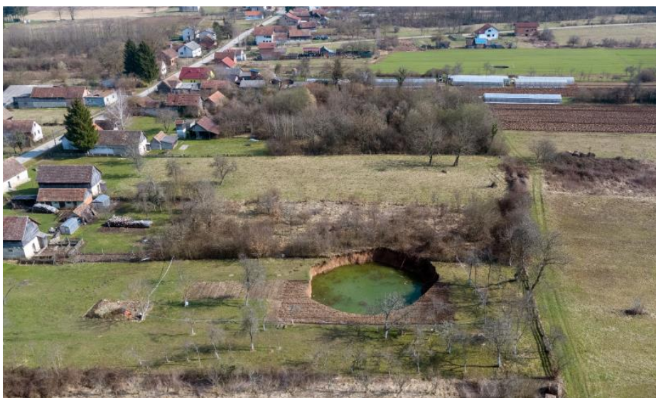
Slika 15. Urušne vrtače u Mečecanima nakon niza potresa 2020. (Izvor: [17])
