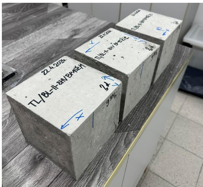
Slika 34. Uzorci lijevanoga betona s PDB-om prije ispitivanja tlačne čvrstoće
