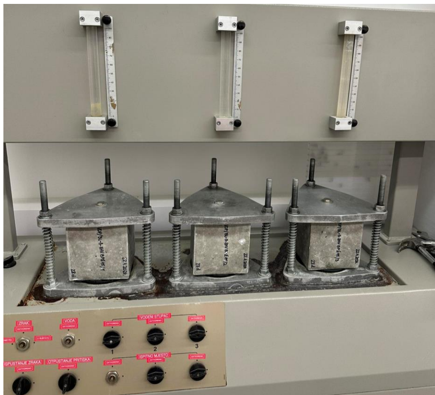
Slika 38. Ispitivanje vodonepropusnosti uzoraka lijevanog betona s PDB-om
