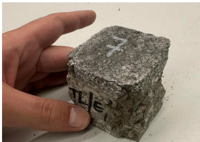
Slika 54. Uzorci vibroprešanog betona nakon ispitivanja tlačne čvrstoće
