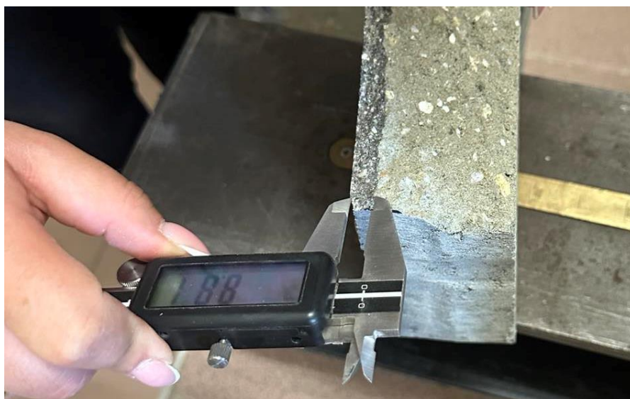
Slika 57. Mjerenje debljina habajućeg sloja nakon sloma
