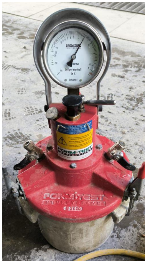
Slika 33. Prikaz ispitivanja sadržaja pora u svježem betonu
