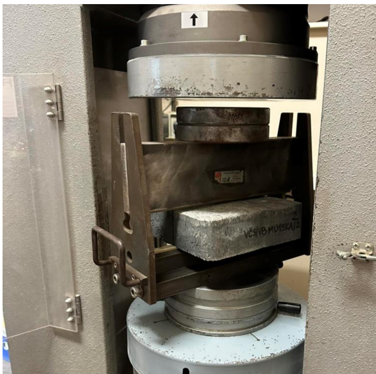
Slika 58. Ispitivanje čvrstoće na cijepanje uzoraka vibroprešanog betona
