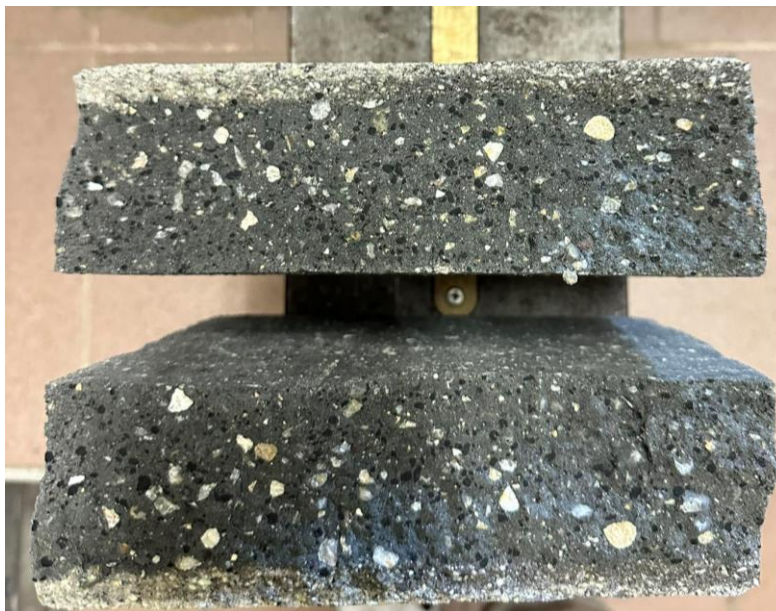
Slika 56. Uzorak nakon ispitivanja čvrstoće na savijanje
