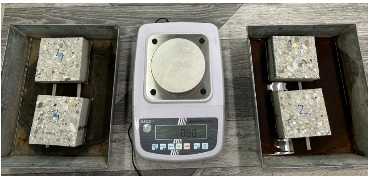
Slika 37. Ispitivanje kapilarnog upijanja uzoraka lijevanoga betona s PDB-om
