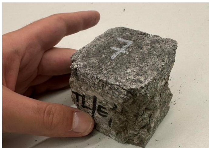
Slika 54. Uzorci vibroprešanog betona nakon ispitivanja tlačne čvrstoće
